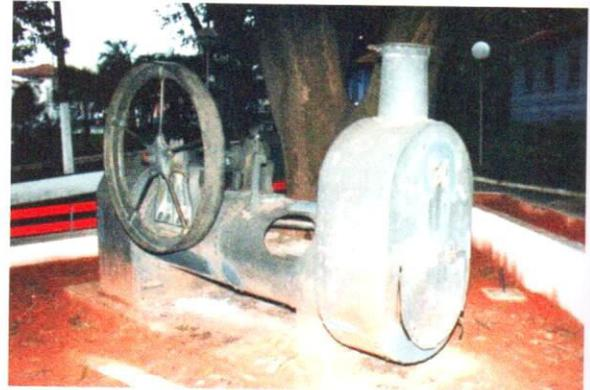
Farm Ibicaba - Dampfmaschine, die von Vergueiro eingesetzt wurde, zum Antrieb der Maschinen zum Trocknen und zur Schälung. Er benutzte ihn auch in seinen Werkstätten. Es war der erste Motor dieser Art, der im Landesinneren des Bundesstaates São Paulo eingesetzt wurde.
